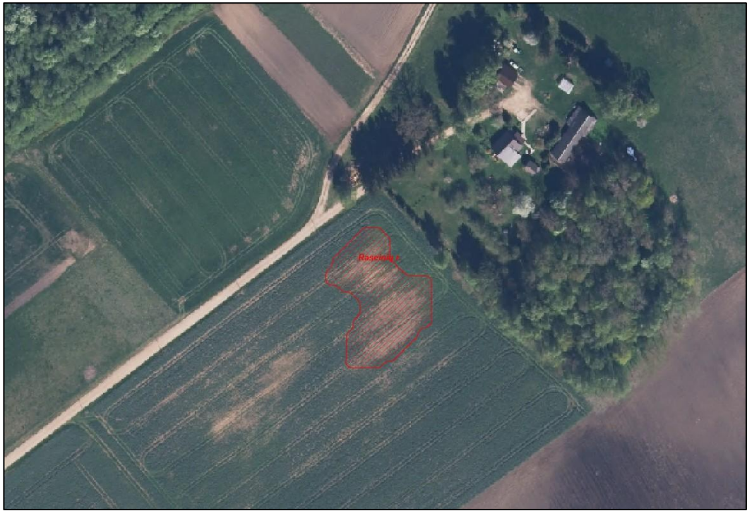
17 pav. Ortofotografinio vaizdo segmentacijos procese dešifruotas blogos būklės melioruotos žemės plotas, kuriame dirvos užmirkimas yra abejotinas.
