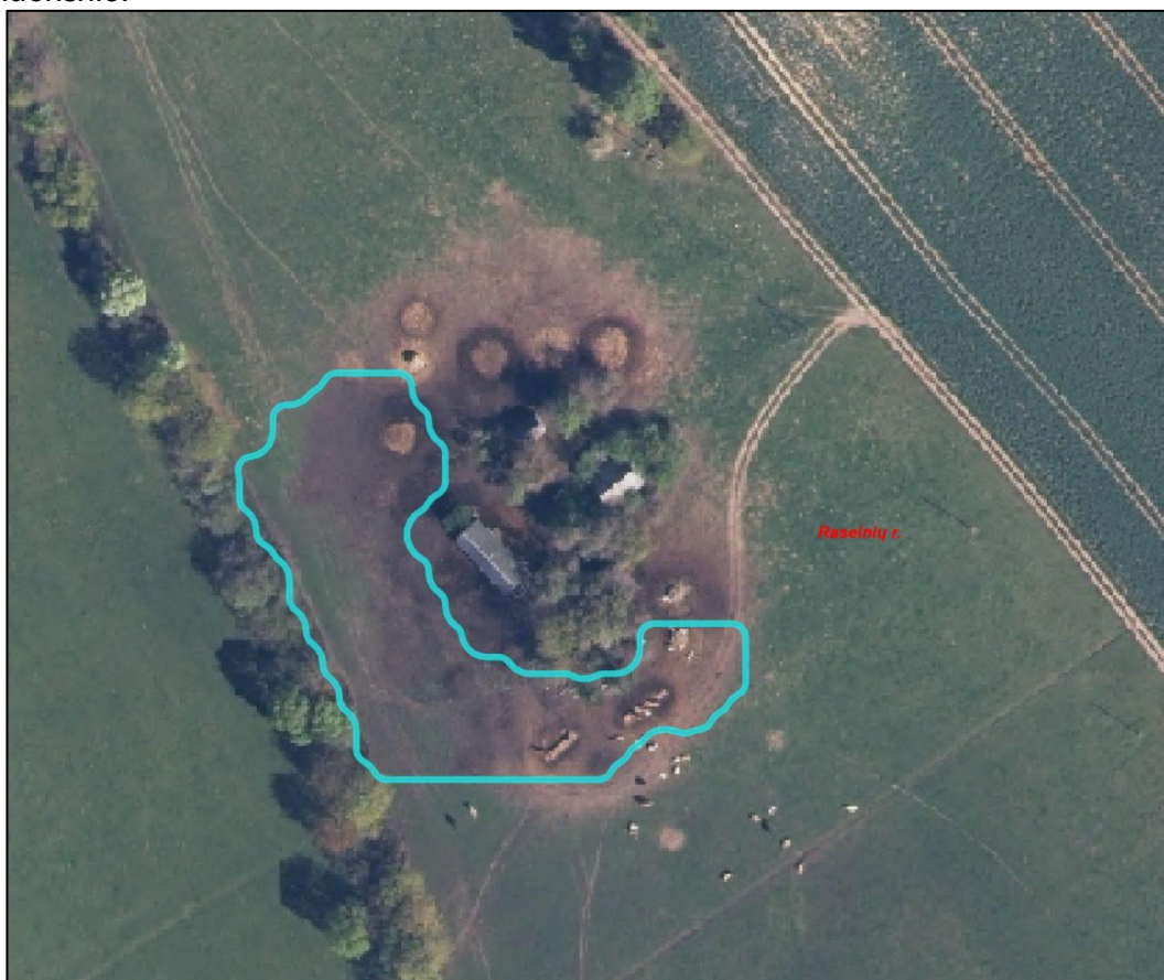
15 pav. Galvijų ištrypta, šlapia, teritorija, ortofotografinio vaizdo segmentacijos procese dešifruota kaip užmirkęs žemės plotas.
