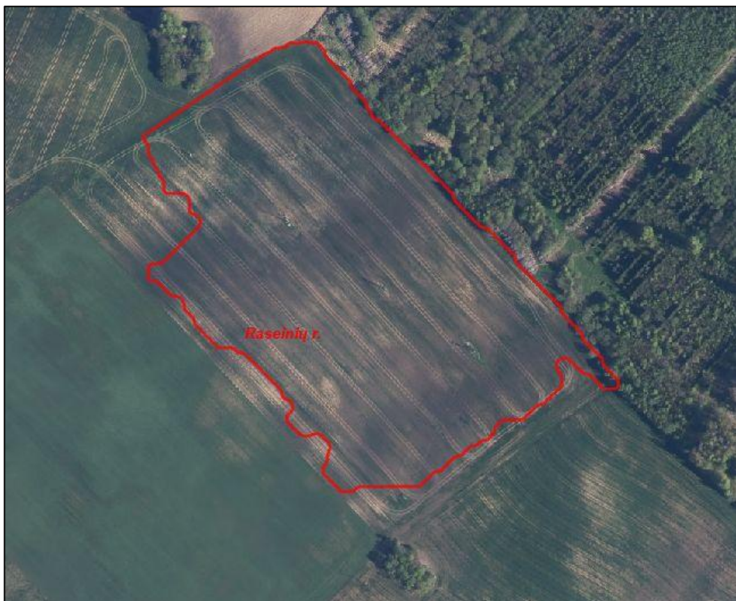
14 pav. Ortofotografinio vaizdo segmentacijos procese dešifruotas žemės plotas, kaip užmirkusi teritorija. Kameralinio apdorojimo metu pašalintas iš galimai blogos būklės melioruotos žemės sluoksnio.
