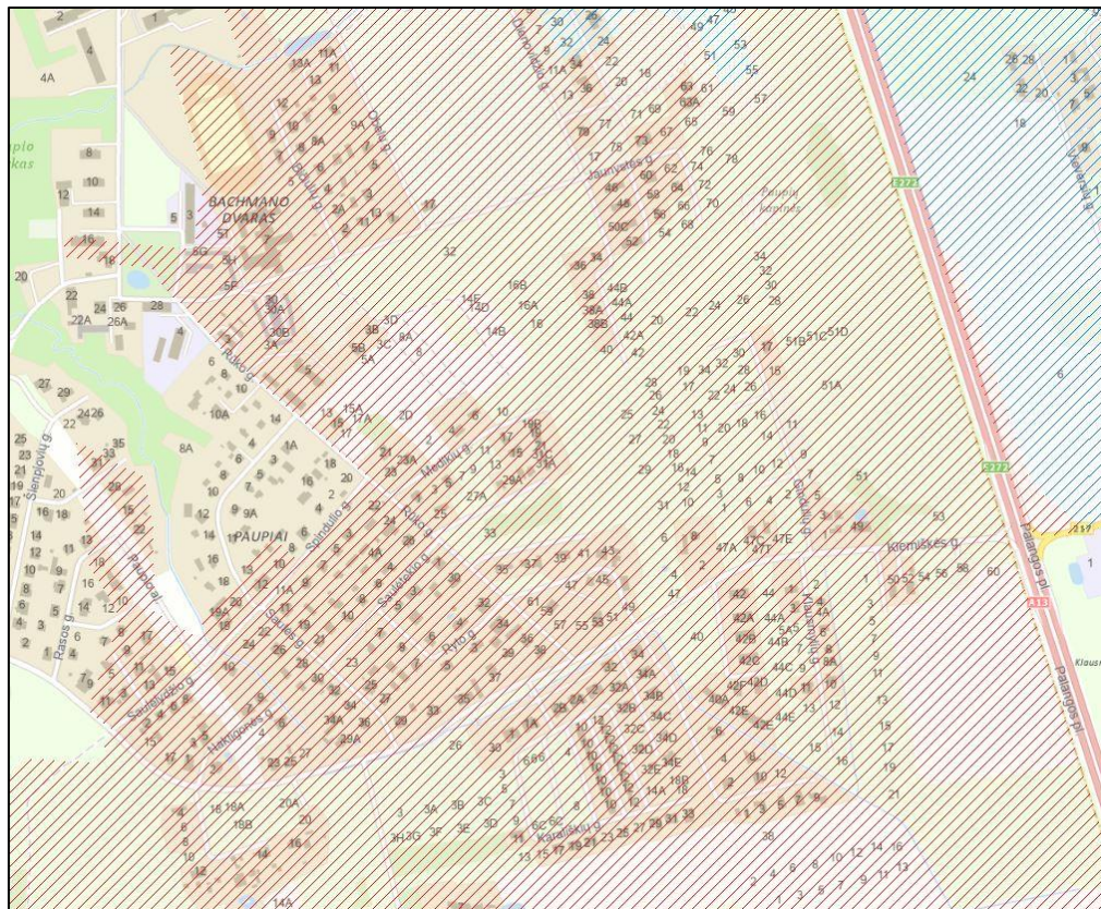
7 pav. Urbanizuotas melioruotos žemės (raudonas štrichas) plotas, kurį netikslinga įtraukti į sluoksnį MELPLOT_P.
