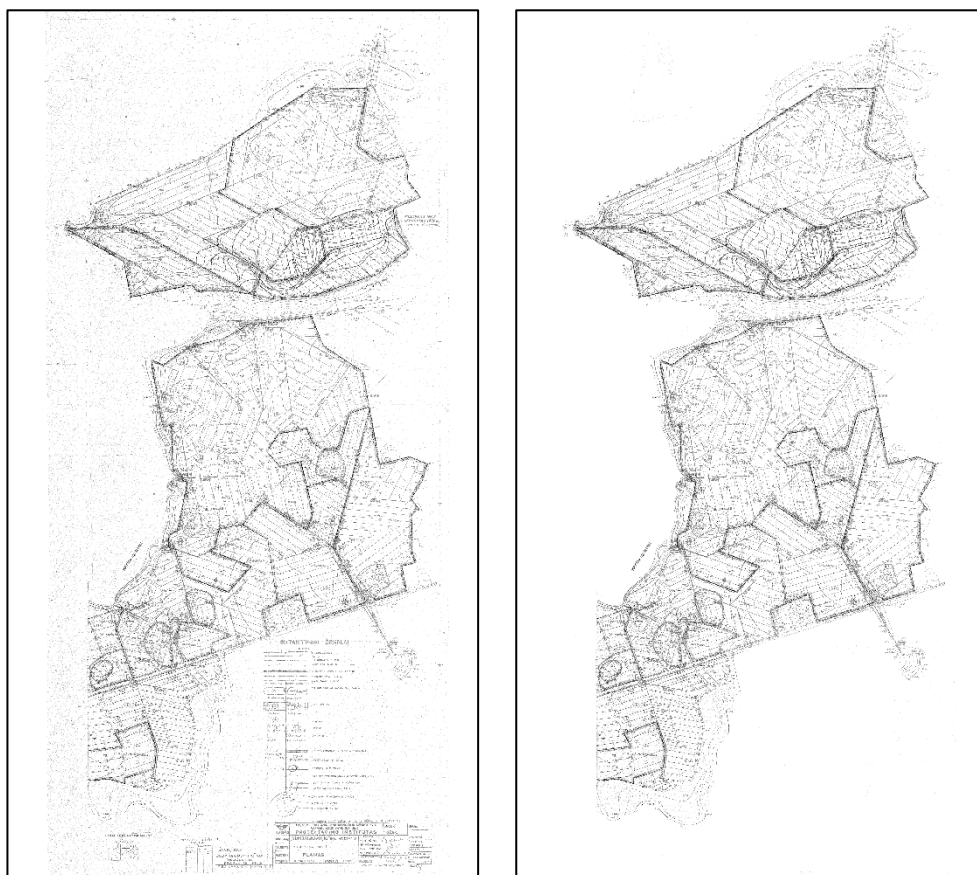
1 pav. Skenuotas, netvarkytas melioracijos planas ir tas pats jau išvalytas melioracijos planas.
